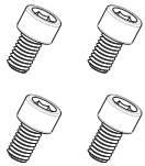
Viti per montare lo schermo Tipo di viti : HMΦ6.0x10mm Q.tà: 4
