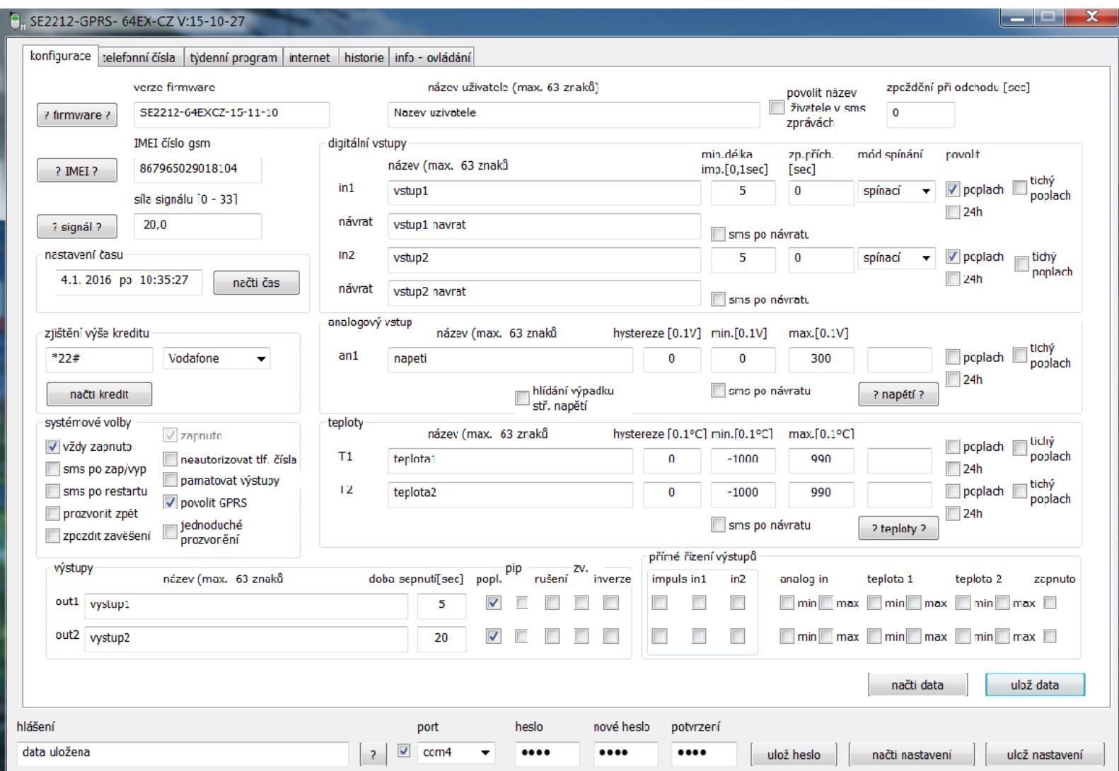
Připojte k zařízení USB kabel a zařízení zapněte. Poté spusťte ovládací program . Tento začne vyhledávat port, na který je zařízení nainstalováno. (Instalace ovladačů viz dále.) Po jeho nalezení změň nastavení rozbalovacího boxu označeného nápisem **port** a zaškrtně políčko nalevo od něho.
